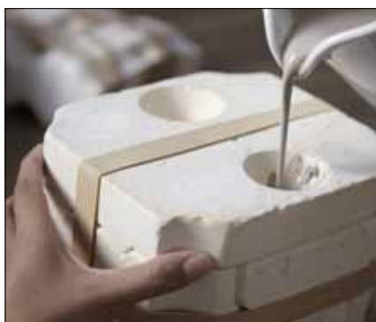
Eingießen der Porzellanmasse Pouring the porcelain mass Coulée de la masse de porcelaine
